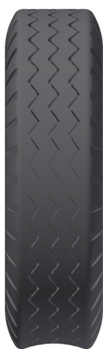
Falta de pressão
